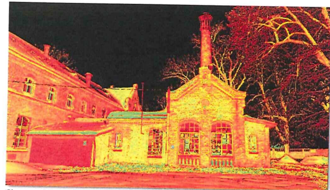
Chmura punktów uzyskana w wyniku skanowania laserowego
