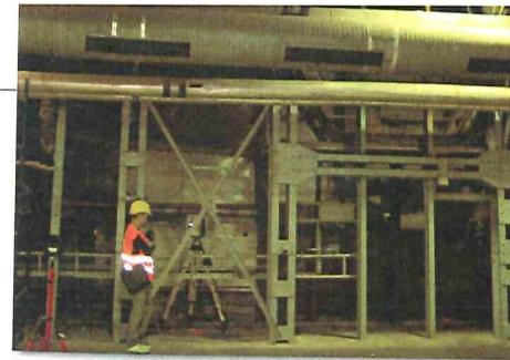
Pomiary skanerem laserowym HDS6100 realizowane przez Fotokart na terenie Elektrowni Szczecin. Fragment numerycznego modelu elektrowni
